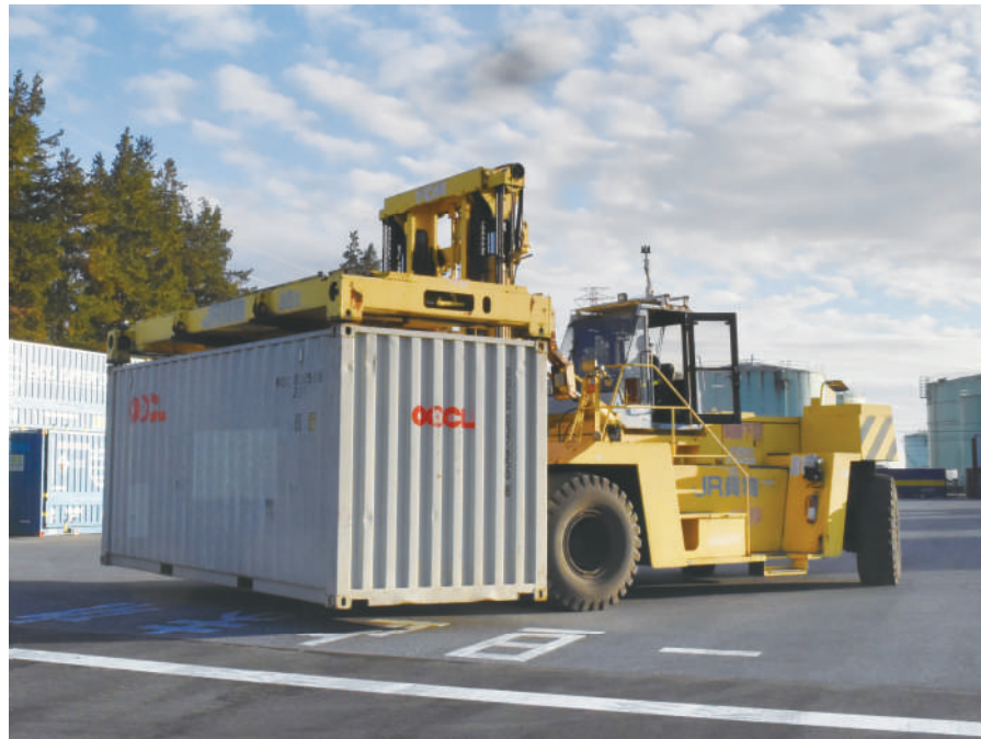
宇都宮貨物ターミナル駅内で大型コンテナを運ぶトップリフター
